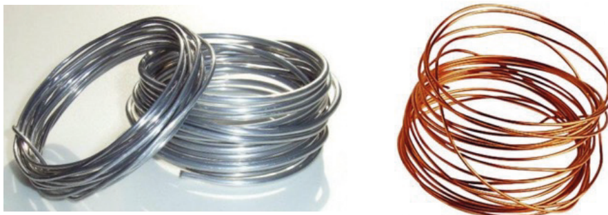
Metales dúctiles como el hierro (a la izquierda) y el cobre (a la derecha).
